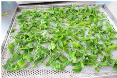
วางให้กระจายบนตะแกรงนำไปอบในตู้อบแบบถาดด้วยลมร้อนที่อุณหภูมิ 60 - 65 องศาเซลเซียส นาน 4 - 6 ชั่วโมง
